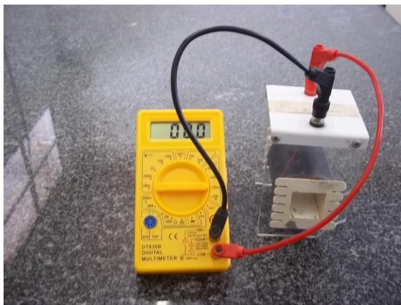
Figura 9 – Montagem experimental para o estudo da lei de Faraday.
