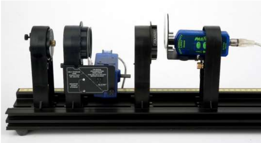
Figura 13: Configuração com Três Polarizadores.
