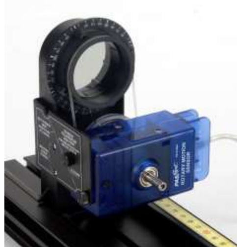
Figure 11: Sensor de Movimento Rotativo Conectado ao Polarizador com Correia.
